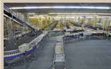
Injection dans la trieuse de contenants « avion »
